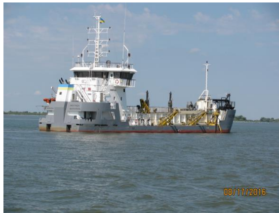
Рисунок 2.6 - Робота земснаряду при поглибленні підхідного каналу
