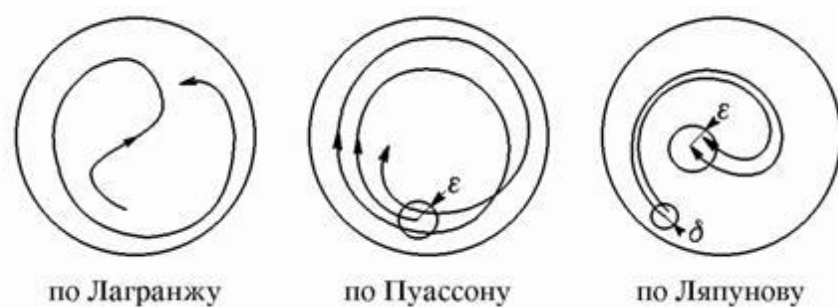
Рисунок 2.2 – Якісна ілюстрація стійкості по Лагранжу (траєкторія залишається в замкнутій області), по Пуассону (траєкторія багаторазово повертається в \epsilon -околицю стартової точки) і по Ляпунову (дві близькі на старті траєкторії залишаються близькими завжди) [50]
