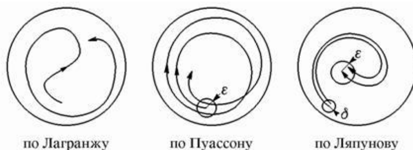
Рисунок 2.2 – Якісна ілюстрація стійкості по Лагранжу (траєкторія залишається в замкнутій області), по Пуассону (траєкторія багаторазово повертається в \epsilon -околицю
